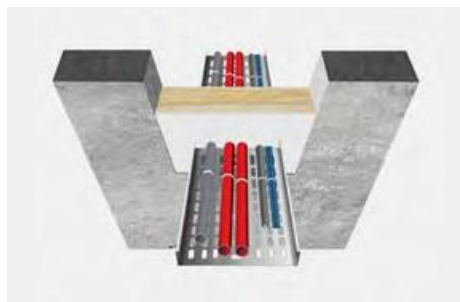
Приклад застосування 1: герметизація кабельних лотків у пробитих стінах.
