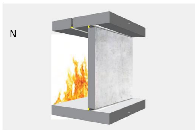
Односторонній шов із Bostik FP 402 Fireseal Silicone у комбінації з підпінним шнуром Bostik
