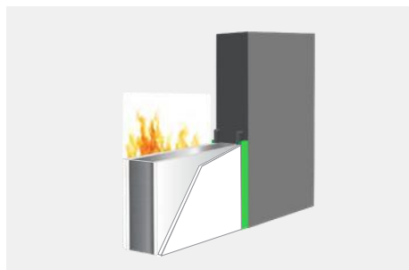
Приклад застосування 2: герметизація між каменем і гіпсокартоном із застосуванням підпінного шнура.
