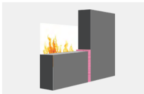
Приклад застосування 1: герметизація між каменем.
