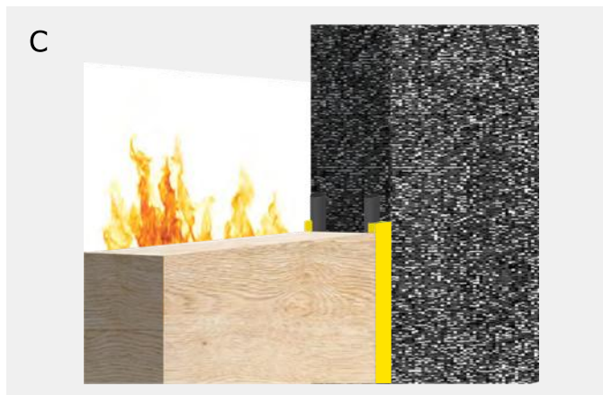
Двосторонній шов із Bostik FP 403 Fireseal Hybrid у комбінації з підпінним шнуром Bostik
