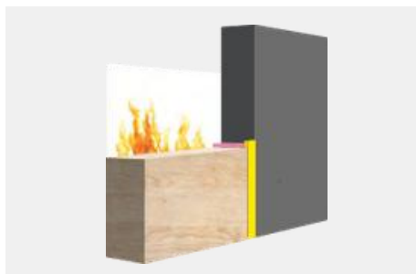
Приклад застосування 2: герметизація між каменем і деревом у комбінації з FP 403 Fireseal Hybrid.
