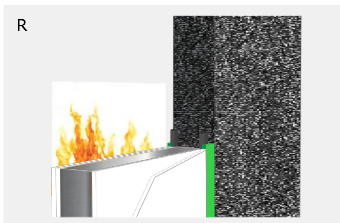
Двосторонній шов із Bostik FP 401 Fireseal Acrylic у комбінації з підпінним шнуром Bostik
