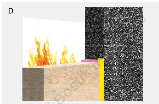
Односторонній шов із Bostik FP 404 Fire Retardant PU Foam у комбінації з Bostik FP 403 Fireseal Hybrid
