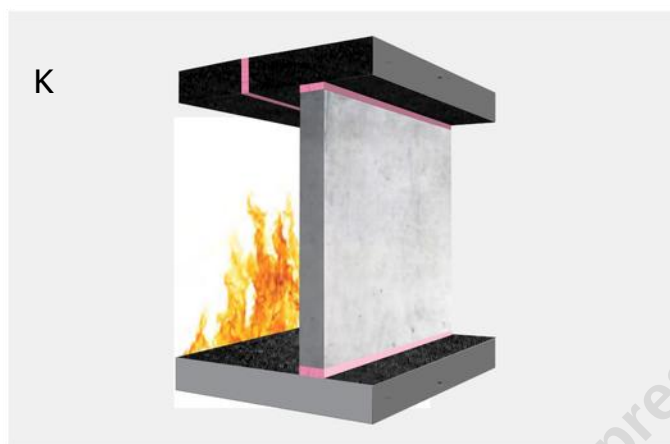
Шов, повністю заповнений Bostik FP 404 Fire Retardant PU Foam
