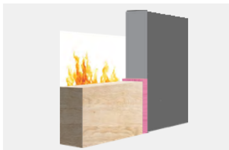
Приклад застосування 1: герметизація між каменем і деревом
