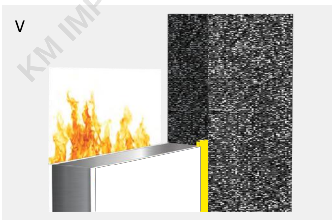
Односторонній шов із Bostik FP 403 Fireseal Hybrid
