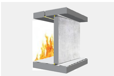
Приклад застосування 1: герметизація між каменем, стіною/перекриттям і стіною/стелею.
