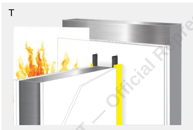
Двосторонній шов у подвійному гіпсокартоні з Bostik FP 403 Fireseal Hybrid у комбінації з підпінним шнуром Bostik
