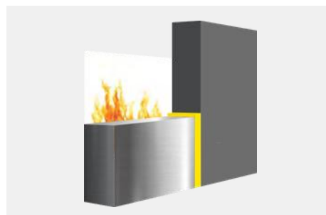
Приклад застосування 2: герметизація між каменем і металом.
